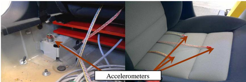
Fig. 9. Accelerometers
